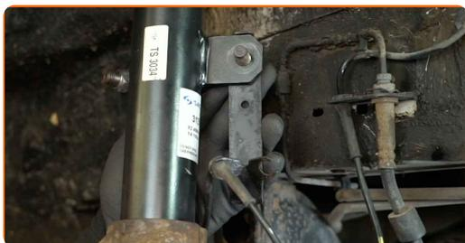
**76** Serrez la fixation reliant la biellette de barre stabilisatrice à la jambe de force. Utilisez une douille de 19 mm. Utilisez une clé dynamométrique. Couple de serrage : 55 N.m.
