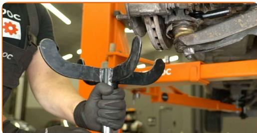
**Remplacement : ressort de suspension – Ford Transit Mk7 van. AUTODOC recommande :**
