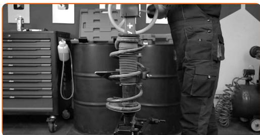
**55** Retirez le palier de montage et la butée d'arrêt.
