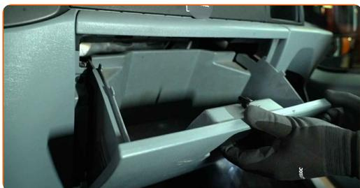
**3** Pressez sur les dispositifs de retenue de la boîte à gants pour la détacher.
