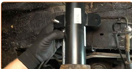
**75** Installez le support du câble du capteur ABS et vissez l'écrou de fixation.
