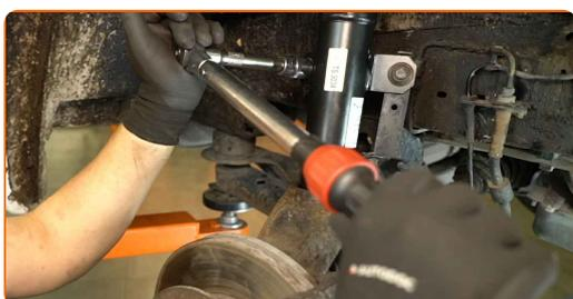
**77** Serrez la fixation du support du câble du capteur ABS. Utilisez une douille de 18 mm. Utilisez une clé dynamométrique. Couple de serrage : 45 N.m.
