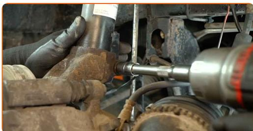
**41** Retirez l'écrou de fixation.
