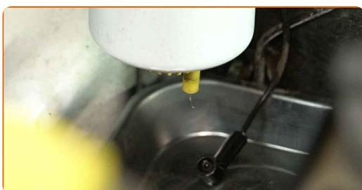
**6** Tournez le filtre dans le sens inverse des aiguilles d'une montre d'un quart de tour, puis retirez-le.
