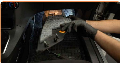
**6** Dévissez les attaches du couvercle du boîtier du filtre d'habitacle. Utilisez la mèche Torx T20. Utilisez une clé à cliquet.
