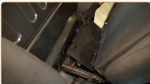
4 Dévissez la fixation de la borne négative de la batterie. Utilisez une douille de 10 mm. Utilisez une clé à cliquet.
