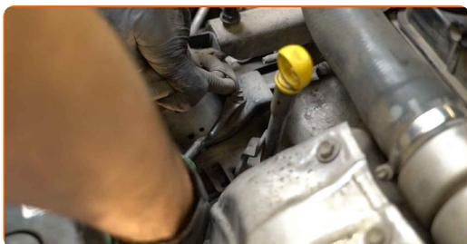
**20** Débranchez le connecteur du faisceau de câbles du moteur.
