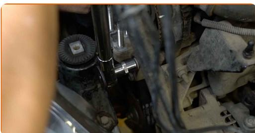
**94** Appliquez du produit sur les boulons de serrage. Utilisez un enduit.
