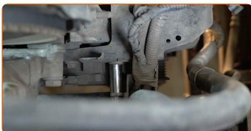
**22** Détachez le clip du faisceau de câbles du moteur du carter de distribution. Utilisez un outil d'extraction de clips.
