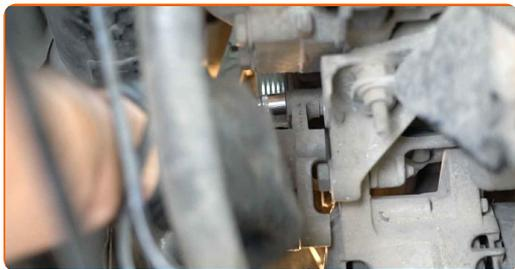
**27** Retirez le galet tendeur de la courroie poly-V.
