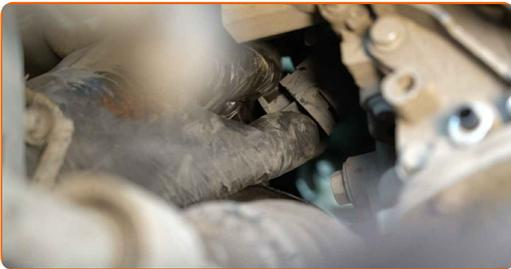
**45** Retirez le bouchon de vidange du liquide de refroidissement.
