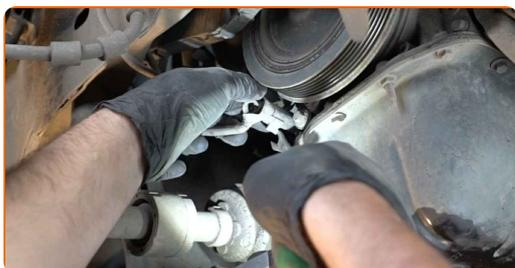
**29** Détachez le câblage du capteur de position du vilebrequin. Utilisez un outil d'extraction de clips.
