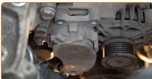
**109** Installez le support du faisceau de câbles de l'alternateur.
