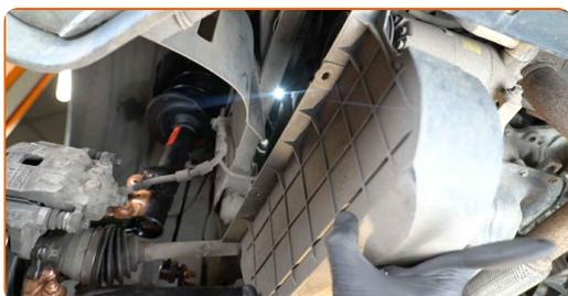
**11** Mettez de côté la poulie de tendeur de la courroie en V crantée. Utilisez une clé mixte de No.15.
