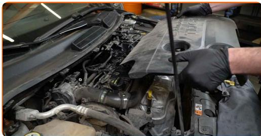
Remplacement : pompe à eau & kit de courroie de distribution – FORD Transit Courier Van. Les professionnels recommandent :
