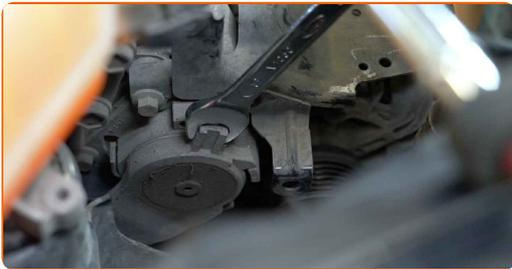
**24** Dévissez les fixations du support du faisceau de câbles de l'alternateur. Utilisez une douille n° 10. Utilisez une clé à cliquet.
