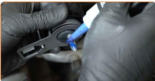
**78** Installez le galet tendeur de la courroie de distribution.
