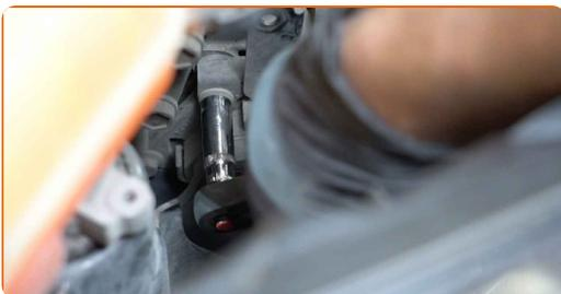
**25** Retirez le support du faisceau de câbles de l'alternateur.
