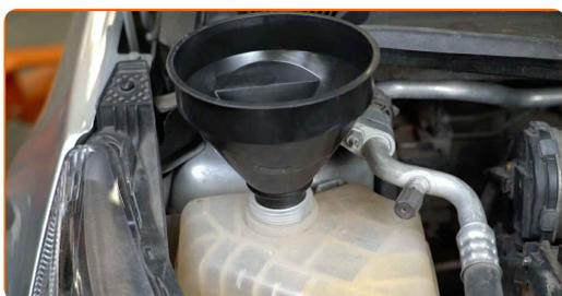
**147** Versez du liquide de refroidissement dans le réservoir.
