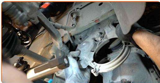
**39** Dévissez la fixation du capteur de position du vilebrequin. Utilisez une douille n° 8. Utilisez une clé à cliquet.
