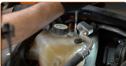
**53** Retirez le réservoir de liquide de refroidissement.
