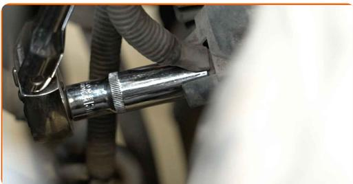
**132** Installez le cache de la fixation du faisceau de câbles de l'alternateur.
