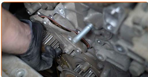
Remplacement : pompe à eau & kit de courroie de distribution – FORD Transit Courier Van. Les experts d'AUTODOC recommandent :
