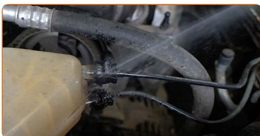
**48** Détachez les tuyaux de refroidissement du réservoir de liquide de refroidissement.
