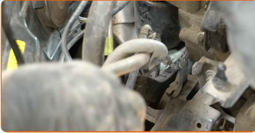
**23** Mettez de côté la poulie de tendeur de la courroie en V crantée. Utilisez une clé mixte de No.15.
