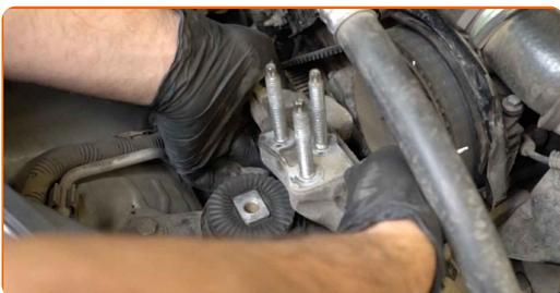
**91** Appliquez du produit sur les fixations du support moteur. Utilisez un enduit.
