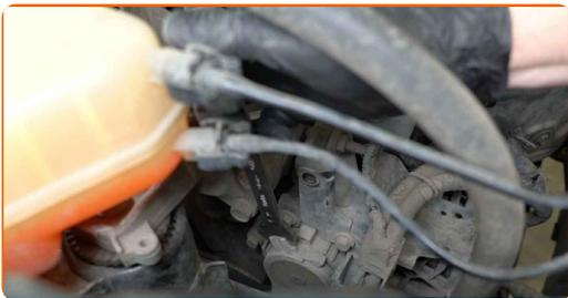
**14** Débranchez le connecteur du compresseur du système de climatisation.
