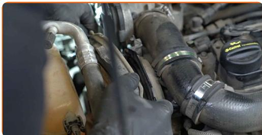
**9** Dévissez les fixations du carter de la courroie poly-V inférieure. Utilisez la mèche Torx T30. Utilisez une clé à cliquet.
