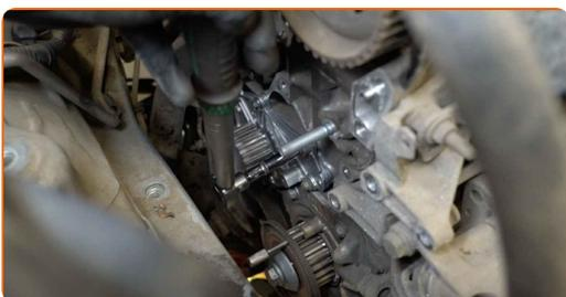
**77** Appliquez du produit sur les boulons de serrage. Utilisez un enduit.
