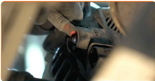
**19** Détachez le clip du faisceau de câbles de l'alternateur de son support. Utilisez un outil d'extraction de clips.
