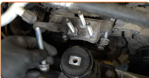
**93** Serrez les écrous de fixation du support moteur. Utilisez une douille n° 16. Utilisez une clé dynamométrique. Serrez-le jusqu'à 55 Nm.
