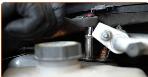
**117** Raccordez les tuyaux de refroidissement au réservoir de liquide de refroidissement.
