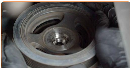
**106** Serrez la fixation de la poulie de vilebrequin. Utilisez une douille n° 18. Utilisez une clé dynamométrique. Serrez-le jusqu'à 35 Nm.+190°
