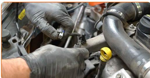
**21** Dévissez les fixations du support du faisceau de câbles du moteur. Utilisez une douille n° 10. Utilisez une clé à cliquet.
