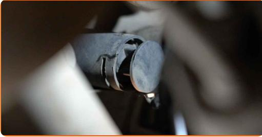
**44** Retirez le clip de retenue du bouchon de vidange du liquide de refroidissement.
