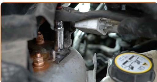
**52** Débloquez le reteneur du réservoir de liquide de refroidissement. Utilisez un outil d'extraction de clips.
