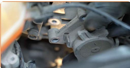
**26** Dévissez la fixation du galet tendeur de la courroie poly-V. Utilisez une douille n° 10. Utilisez une clé à cliquet.
