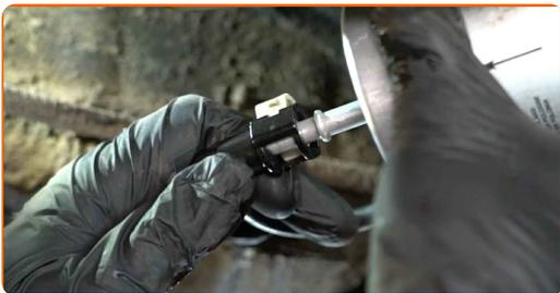
**18** Vissez le support de montage du filtre à carburant. Utilisez une douille n° 8. Utilisez une clé à cliquet.
