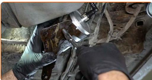
**19** Vissez les boulons de fixation du support du filtre à carburant. Utilisez une douille n° 10. Utilisez une clé à cliquet.
