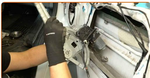
**20** Installez un mécanisme de lève-vitre neuf.
