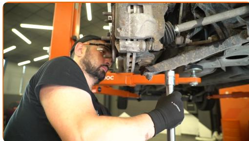
Remplacement : rotule de suspension – FORD Transit Mk5 Camion plate-forme/Châssis (V184, V185). Les experts d'AUTODOC recommandent :
