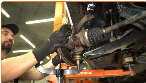
**Remplacement : rotule de suspension – FORD Transit Mk5 Camion plate-forme/Châssis (V184, V185). Conseil :**
