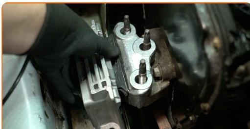
11 Installez les écrous et les boulons de fixation.
