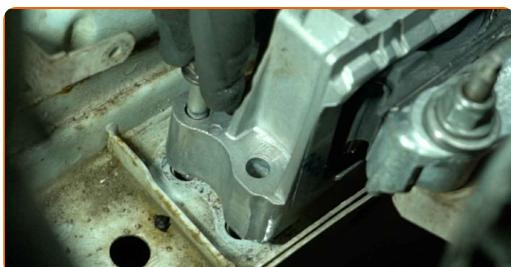
12 Serrez les fixations supérieures du support du moteur. Utilisez une douille d'entraînement de 18 mm. Utilisez une clé dynamométrique. Couple de serrage : 115 Nm.
