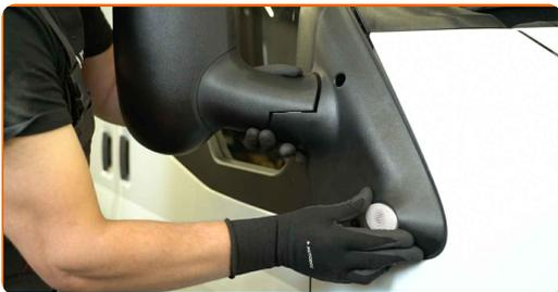
**11** Installez les écrous de fixation.
