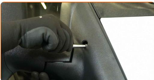
**12** Vissez les fixations du rétroviseur latéral. Utilisez une douille d'entraînement de 8 mm. Utilisez une clé à cliquet.
