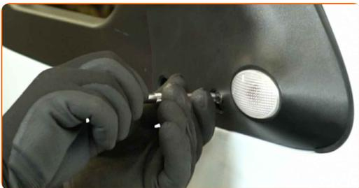
**13** Remettez en place les caches des fixations du rétroviseur latéral.
