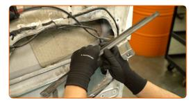
Dévissez les fixations de la serrure de la portière. Utilisez un embout Torx T30. Utilisez un tournevis électrique ou à cliquet.
