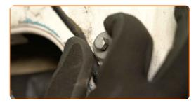
Serrez les fixations du rail de guidage de la vitre. Utilisez une douille d'entraînement de 8 mm. Utilisez une clé dynamométrique. Couple de serrage : 10 Nm.
