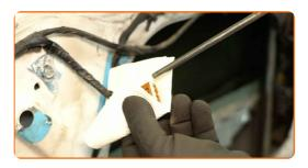
Raccordez le connecteur au commutateur de la vitre électrique.
