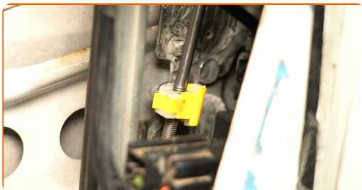
**26** Appliquez du produit sur le connecteur du commutateur de la vitre électrique. Utilisez une bombe pour contacts électriques.
