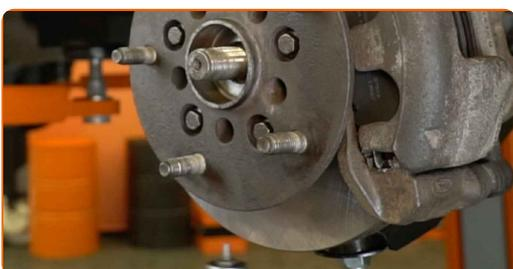
Remplacement : disques de frein – FORD Transit Mk6 Camion plate-forme/Châssis (V347, V348). AUTODOC recommande :
