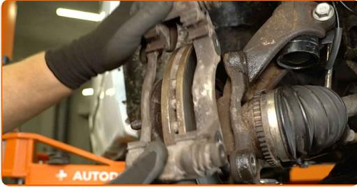
30 Dévissez les fixations des roulements de roue. Utilisez un embout Torx T50. Utilisez une clé à cliquet.
