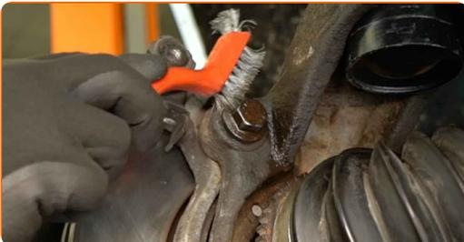
**27** Dévissez les fixations du support d'étrier de frein. Utilisez une douille de 18 mm. Utilisez une barre de force en T.
