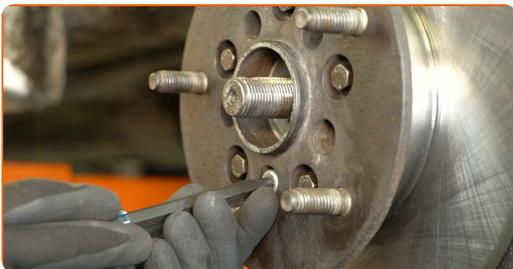
49 Serrez les boulons de fixation des roulements de roue. Utilisez un embout Torx T50. Utilisez une clé dynamométrique. Couple de serrage : 53 Nm.
