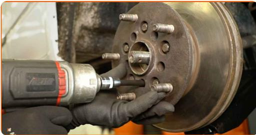
31 Retirez les boulons de fixation.
