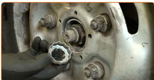
8 Nettoyez l'écrou de l'essieu. Utilisez une brosse métallique. Utilisez un spray WD-40.
