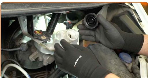
78 Serrez le bouchon du réservoir de liquide de frein.
