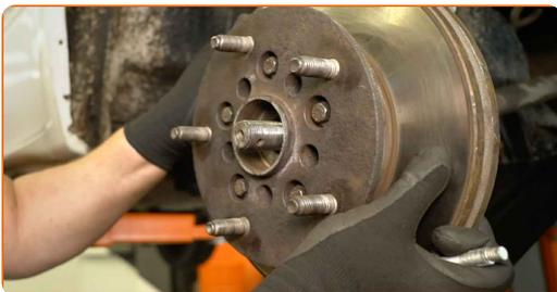
33 Nettoyez le siège de montage du roulement de roue. Utilisez une brosse métallique. Utilisez un spray nettoyant multi-usages.
