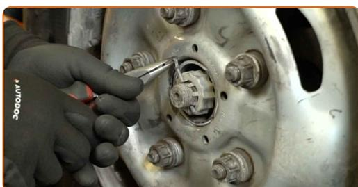
7 Retirez le cache écrou de l'écrou de l'essieu.
