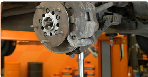
16 Détachez le demi-arbre de transmission de la fusée d'essieu. Utilisez un chasse-goupille. Utilisez un marteau.
