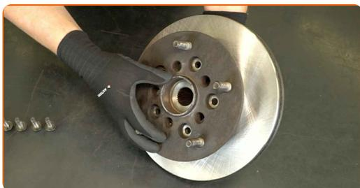
44 Installez les boulons de fixation.
