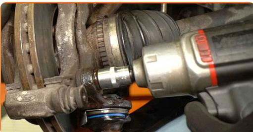
**28** Retirez les boulons de fixation.
