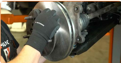
48 Installez les boulons de fixation.
