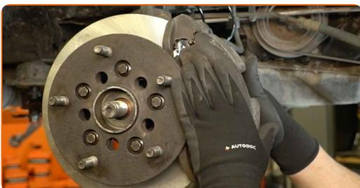
61 Installez les boulons de fixation.
