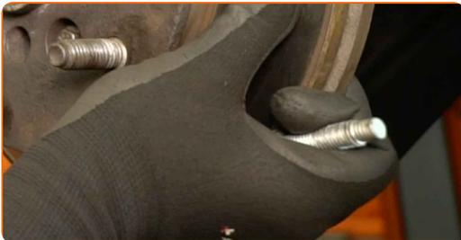
32 Retirez le moyeu de la roue ainsi que le disque de frein.
