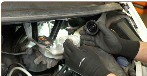
**32** Serrez le bouchon du réservoir de liquide de frein.
