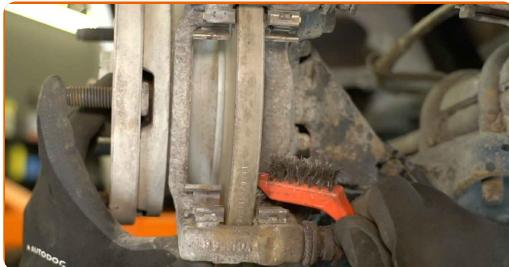
Remplacement : plaquettes de frein – FORD Transit Mk6 Camion plate-forme/Châssis (V347, V348). AUTODOC recommande :
