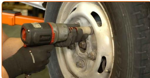
Remplacement : plaquettes de frein – FORD Transit Mk6 Camion plate-forme/Châssis (V347, V348). Conseil :
