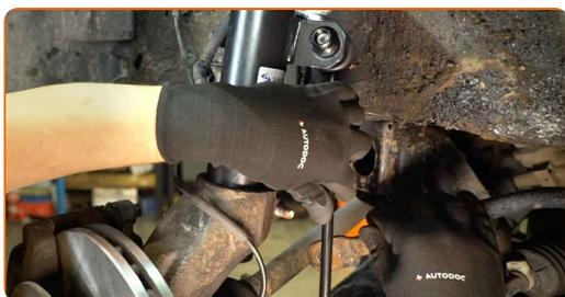
**13** Serrez la fixation reliant la biellette de barre stabilisatrice à la barre stabilisatrice. Utilisez une clé mixte de 20 mm. Utilisez une douille de 17 mm. Utilisez une clé dynamométrique. Couple de serrage : 55 N.m.
