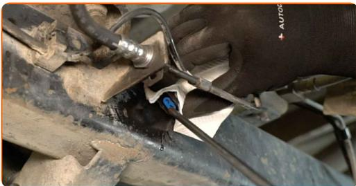
19 Fixez le connecteur au capteur d'usure de plaquette de frein.
