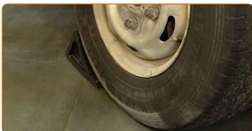
4 Desserrez les écrous de roue. Utilisez une douille à choc pour jantes 21 mm. Utilisez une barre de force en T.
