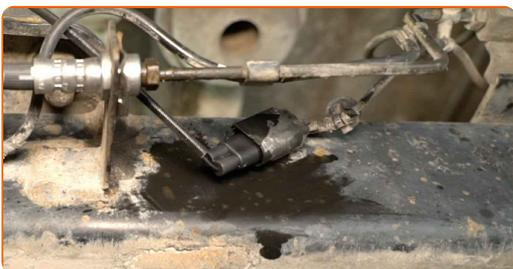
20 Fixez le câble du capteur d'usure de plaquette de frein.
