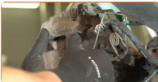
Remplacement : contacteur de témoin d'usure plaquette de frein – FORD Transit Mk6 Minibus (V347, V348). Les experts d'AUTODOC recommandent :
