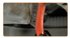
Dévissez le bouchon de vidange. Utilisez une douille d'entraînement de 13 mm. Utilisez une clé à cliquet.
