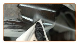
Vissez le bouchon de vidange et serrez-le. Utilisez une douille d'entraînement de 13 mm. Utilisez une clé dynamométrique. Couple de serrage : 23 Nm.
