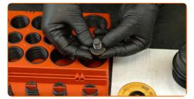
Installez un joint torique neuf sur le bouchon du filtre à huile.
