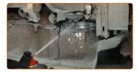
Installez le bouchon du filtre à huile et vissez-le. Utilisez une douille d'entraînement de 30 mm. Utilisez une clé dynamométrique. Couple de serrage : 20 Nm.
