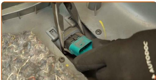
9 Installez l'interrupteur de vitre électrique neuf sur le panneau de portière.
