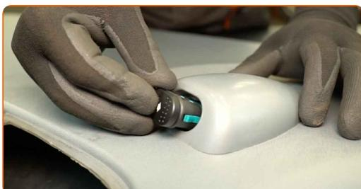
10 Raccordez le connecteur au commutateur de la vitre électrique.
