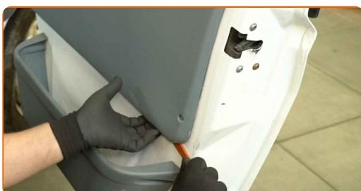
**Remplacement : commutateur de lève-vitre électrique – FORD Transit Mk6 Minibus (V347, V348). AUTODOC recommande :**
