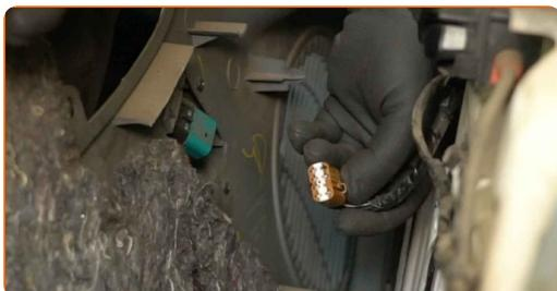
7 Appliquez du produit sur le connecteur du commutateur de la vitre électrique. Utilisez une bombe pour contacts électriques.
