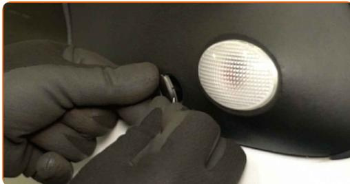
**2** Dévissez les fixations du rétroviseur latéral. Utilisez une douille d'entraînement de 8 mm. Utilisez une clé à cliquet.
