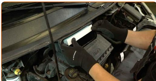
Remplacement : filtre d'habitacle – FORD Transit Mk6 Camion à Plateau/Châssis (V347, V348). Les professionnels recommandent :
