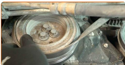
**4** Vérifiez l'état des poulies de l'alternateur et de la pompe de direction assistée. Remplacez-les si nécessaire.
