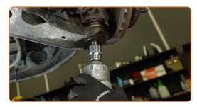
Levez la fusée d'essieu. Utilisez un vérin de transmission ou un cric de véhicule supplémentaire.
