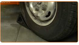
Desserrez les écrous de roue. Utilisez une douille à choc pour jantes de 21 mm. Utilisez une barre de force en T.
