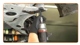
Retirez l'écrou de fixation.
