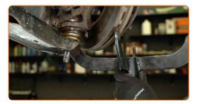
Détachez le joint à rotule du bras de commande. Utilisez un séparateur de joint à rotule.
