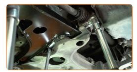
Nettoyez le siège de montage de la jante de roue. Utilisez une brosse métallique. Utilisez un spray nettoyant multiusages.
