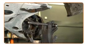
Dévissez la fixation avant du bras de commande. Utilisez une clé mixte de 21 mm. Utilisez une douille de 18 mm. Utilisez une clé à cliquet.
