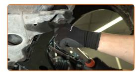
Soulevez les éléments de la suspension pour serrer correctement les fixations. Utilisez un vérin de transmission ou un cric de véhicule supplémentaire.
