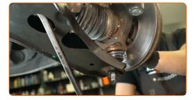
Serrez la fixation qui relie le bras de commande au joint à rotule. Utilisez une douille de 24 mm. Utilisez une clé dynamométrique. Couple de serrage : 150 Nm.
