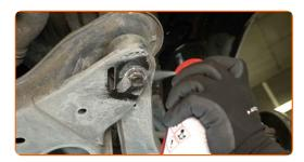
Dévissez les fixations qui relient le joint à rotule au bras de commande. Utilisez une douille de 24 mm. Utilisez une clé à cliquet.
