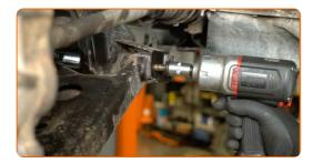
14 Retirez l'écrou de fixation.
