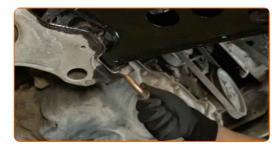
Fixez le joint à rotule au bras de commande en vissant l'écrou.
