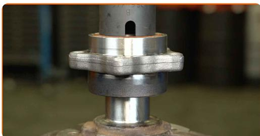
Remplacement : roulement de roue – FORD Transit Mk6 Camion à Plateau/Châssis (V347, V348). Conseil des experts d’AUTODOC :
