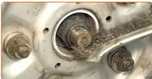
**7** Desserrez l'écrou de l'essieu. Utilisez une douille d'entraînement de 36 mm. Utilisez une barre de force.
