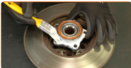
**41** Installez le moyeu de roue et le disque de frein.
