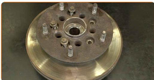
**39** Vissez les fixations du disque de frein. Utilisez une douille d'entraînement de 13 mm. Utilisez une clé à cliquet.
