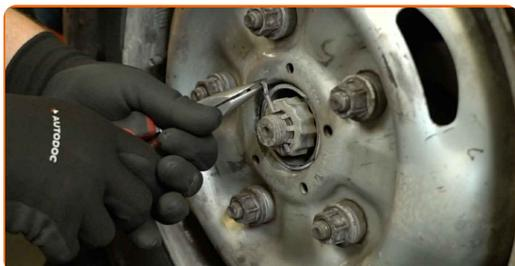
**5** Retirez le cache écrou de l'écrou de l'essieu.
