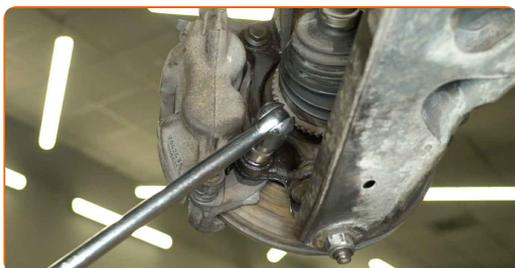
**19** Retirez les écrous de fixation. Utilisez une clé à cliquet.
