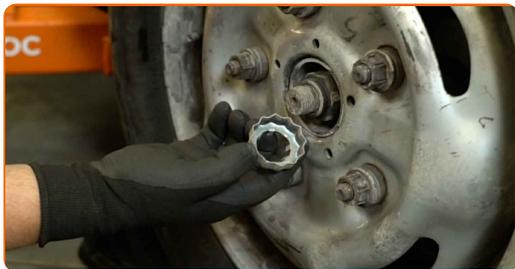
**6** Nettoyez l'écrou de l'essieu. Utilisez une brosse métallique. Utilisez un spray WD-40.
