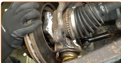
**42** Installez les écrous de fixation.
