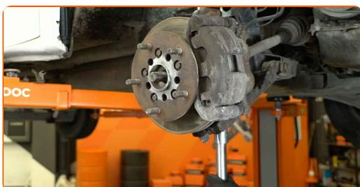
**14** Détachez le demi-arbre de transmission de la fusée d'essieu. Utilisez un chasse-goupille. Utilisez un marteau.
