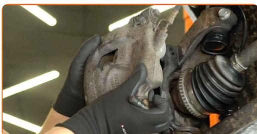
Remplacement : roulement de roue – FORD Transit Mk6 Camion à Plateau/Châssis (V347, V348). AUTODOC recommande :
