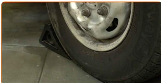
**2** Desserrez les écrous de roue sur les roues avant. Utilisez une douille à choc pour jantes 21 mm. Utilisez une barre de force.
