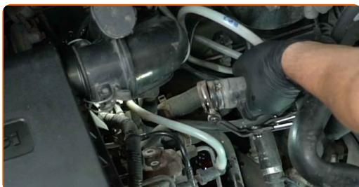
11 Nettoyez les fixations du couvercle du boîtier du thermostat. Utilisez une brosse métallique. Utilisez un spray nettoyant multi-usages.
