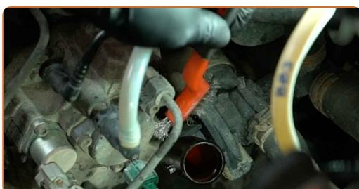
12 Dévissez les fixations du couvercle du boîtier du thermostat. Utilisez un embout Torx T25. Utilisez une rallonge de douille pour joint en U. Utilisez une clé à cliquet.
