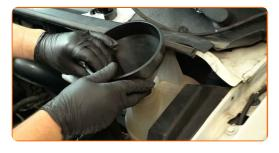
Versez le liquide de refroidissement dans le réservoir.
