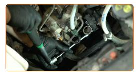
Retirez l'essuie-tout du tuyau de liquide de refroidissement et réattachez-le. Utilisez une pince à collier de serrage.
