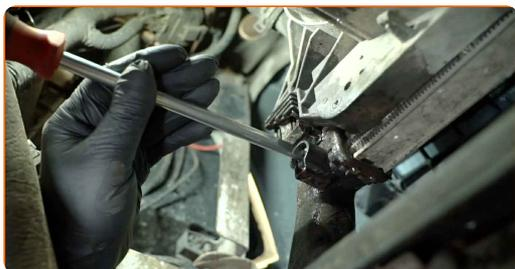
**9** Desserrez le collier de serrage du tuyau de liquide de refroidissement. Utilisez une pince à collier de serrage.
