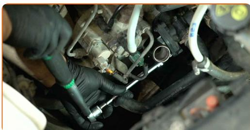
**21** Retirez l'essuie-tout du tuyau de liquide de refroidissement et réattachez-le. Utilisez une pince à collier de serrage.
