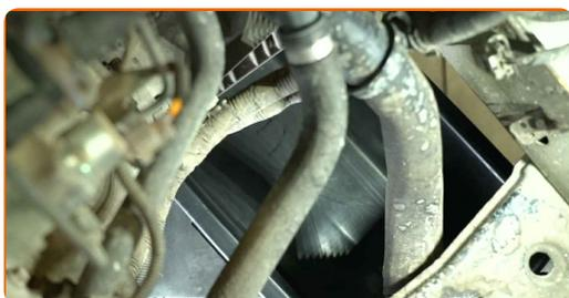
**6** Dévissez le bouchon de vidange du liquide de refroidissement. Utilisez un tournevis à tête plate.
