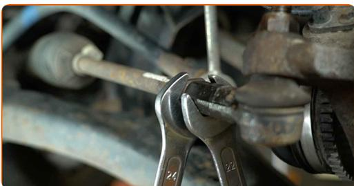
**9** Dévissez l'écrou reliant la rotule de direction à la fusée d'essieu. Utilisez une douille d'entraînement de 22 mm. Utilisez une clé à cliquet.
