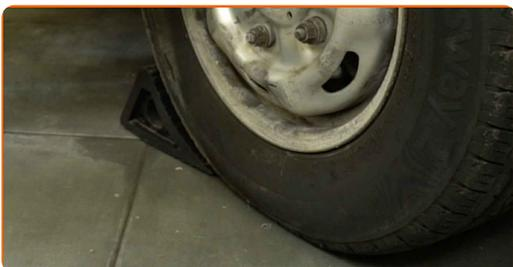
**2** Desserrez les écrous de roue. Utilisez une douille à choc pour jantes de 21 mm. Utilisez une barre de force.
