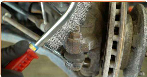
**7** Mesurez et notez la longueur de la partie exposée du filetage de la biellette ou le nombre de tours réalisés par la rotule de direction lors de son dévissage, afin d'éviter tout désalignement des roues lors du remontage. Utilisez un pied à coulisse.
