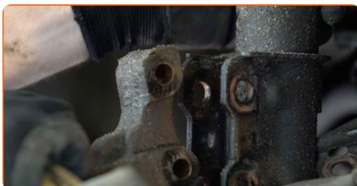
15 Dévissez l'attache supérieure de l'entretoise de l'amortisseur. Utilisez une clé mixte de No.19. Utilisez une douille n° 9. Utilisez une clé à cliquet.
