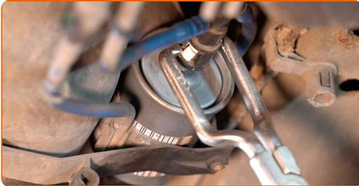
Remplacement : filtre à carburant – Opel Astra G F48. AUTODOC recommande
