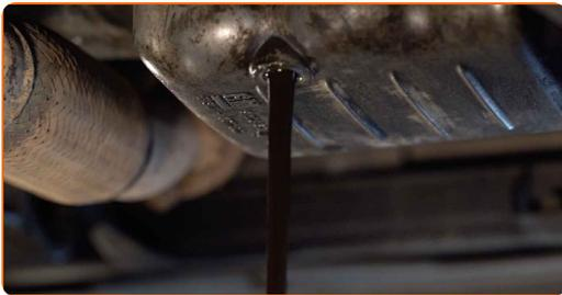
Remplacement : huile moteur et filtre à huile – Opel Astra G F48. Les professionnels recommandent :
