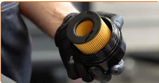
20 Lubrifiez le joint en caoutchouc du nouveau filtre avec une petite quantité d'huile neuve.
