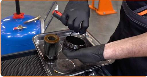
18 Installez les nouveaux filtres à huile sur les sièges de montage sur le couvercle du filtre.
