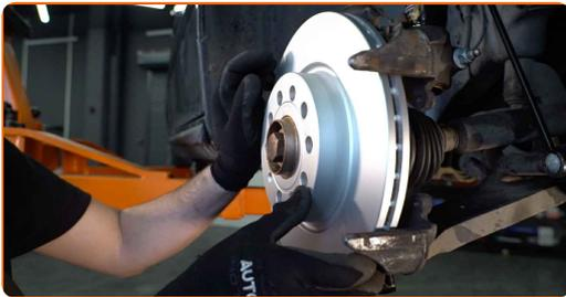
16 Serrez l'attache du disque de frein. Servez-vous d'un tournevis Phillips. Utilisez une clé dynamométrique. Serrez-le jusqu'à 4 Nm.
