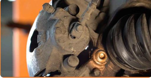
23 Appliquez du produit sur la zone de contact entre le disque de frein et la jante. Utilisez de la graisse au cuivre.
