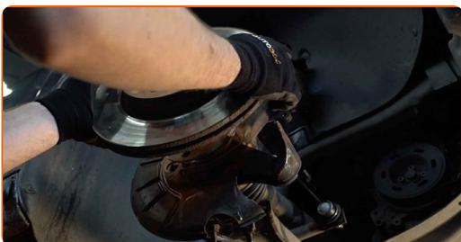
14 Nettoyez le moyeu. Utilisez une brosse métallique. Traitez la surface de contact. Utilisez de la graisse au cuivre.
