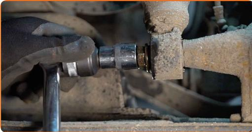
15 Dévissez l'attache supérieure de l'amortisseur. Utilisez une douille n° 10. Utilisez une clé à cliquet.
