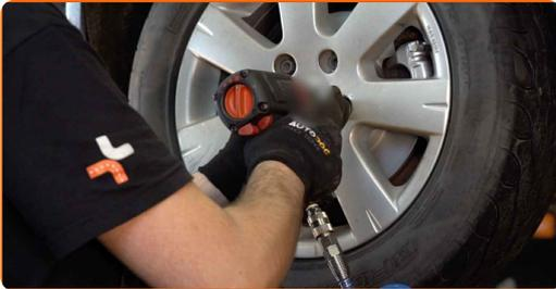
44 Abaissez la voiture et serrez les boulons de roue en ordre croisé. Utilisez une clé dynamométrique. Serrez-les jusqu'à 120 Nm.
