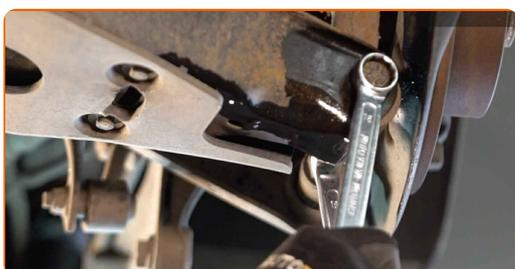
14 Retirez l'écrou de fixation.
