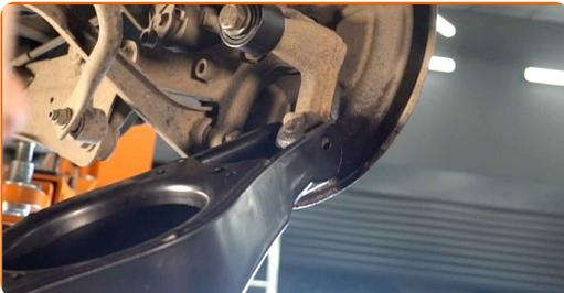
Remplacement : bras de commande inférieur de suspension arrière – VW Golf 5. Conseil :
