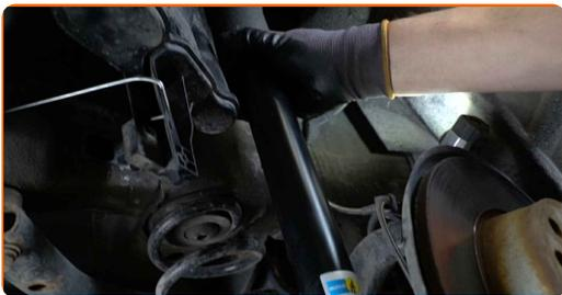
**33** Installez l'écrou de fixation.
