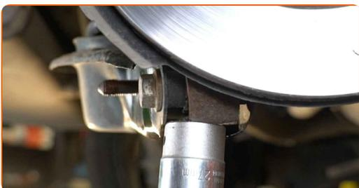
**35** Installez les boulons de fixation.
