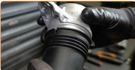
**28** Serrez l'écrou de la tige de l'amortisseur. Utilisez une douille n° 16. Servez-vous d'un embout d'amortisseur DDN°6. Utilisez une clé dynamométrique. Serrez-le jusqu'à 25 Nm.
