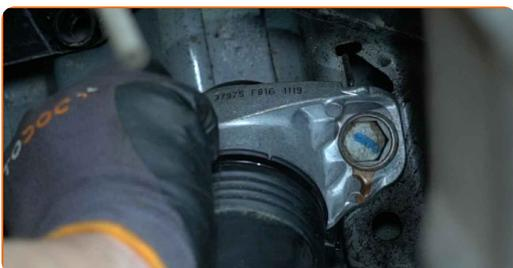
**36** Serrez les fixations du support de l'amortisseur. Utilisez une douille n° 16. Utilisez une clé dynamométrique. Serrez-le jusqu'à 50 Nm. +45°
