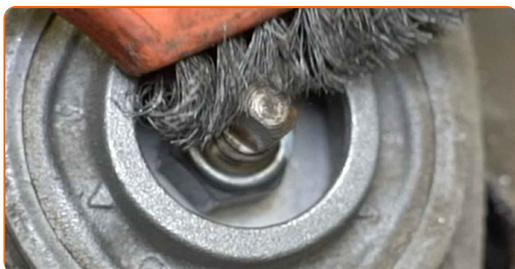
**25** Retirez la fixation de la tige de piston de l'amortisseur. Utilisez une douille n° 16. Servez-vous d'un embout d'amortisseur DDN°5,2. Utilisez une clé à cliquet.
