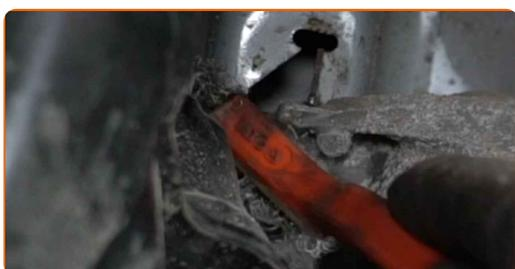
**16** Dévissez les fixations du support de l'amortisseur. Utilisez une douille n° 16. Utilisez une clé à cliquet.
