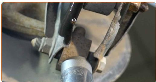
**8** Dévissez l'attache inférieure de l'amortisseur. Utilisez une clé mixte de No.18. Utilisez une douille n° 18. Utilisez une clé à cliquet.
