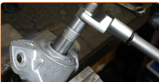
**29** Appliquez du produit sur l'élément de fixation de la tige de l'amortisseur. Utilisez de la graisse au cuivre.
