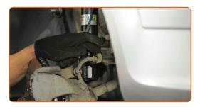
Attachez le connecteur du capteur ABS.
