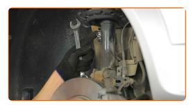
Dévissez la fixation reliant la biellette à l'amortisseur. Utilisez une clé mixte de No.19. Utilisez une douille n° 19. Utilisez une clé à cliquet.
