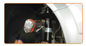
Appliquez du produit sur les fixations de l'amortisseur. Appliquez du produit sur tous les joints du stabilisateur. Utilisez de la graisse au cuivre.
