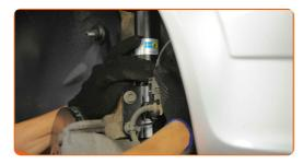
Serrez les fixations inférieures qui relient l'amortisseur à la fusée d'essieu. Utilisez une clé mixte de No.18. Utilisez une douille n° 18. Utilisez une clé dynamométrique. Serrez-le jusqu'à 85 Nm.+90°
