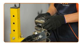
Serrez l'écrou de l'entretoise d'amortisseur due la tige de piston. Utilisez une douille n° 21. Utilisez une clé dynamométrique. Serrez-le jusqu'à 65 Nm.
