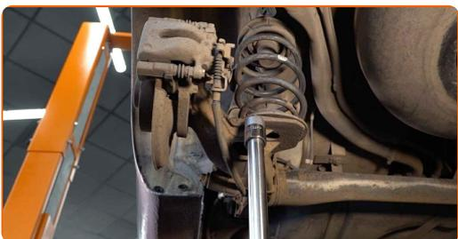
**9** Dévissez l'attache inférieure de l'amortisseur. Utilisez une douille n° E20. Utilisez une clé à cliquet.
