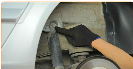
**7** Desserrez l'attache inférieure de l'amortisseur. Utilisez une douille n° E20. Utilisez une clé à cliquet.
