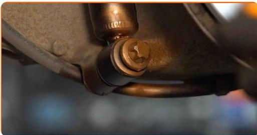
**22** Appliquez du produit sur la zone de contact entre le disque de frein et la jante. Utilisez de la graisse au cuivre.
