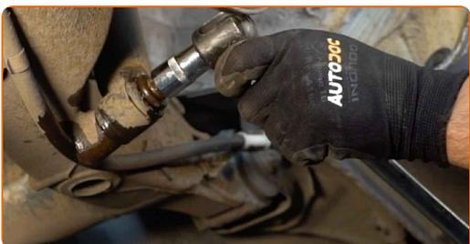
**10** Retirez l'écrou de fixation.
