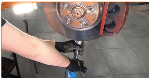
21 Déconnectez le support de montage du tuyau de frein. Utilisez une douille n° 12. Utilisez une clé à cliquet.
