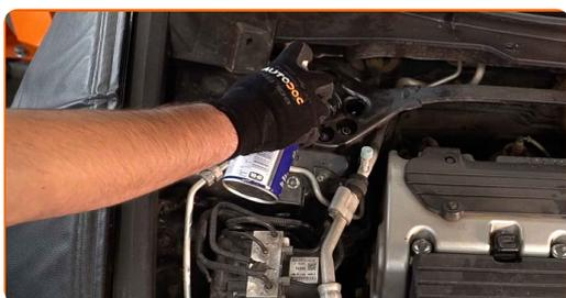
4 Devissez la fixation supérieure du support d'amortisseur. Utilisez une douille n° 14. Utilisez une clé à cliquet.
