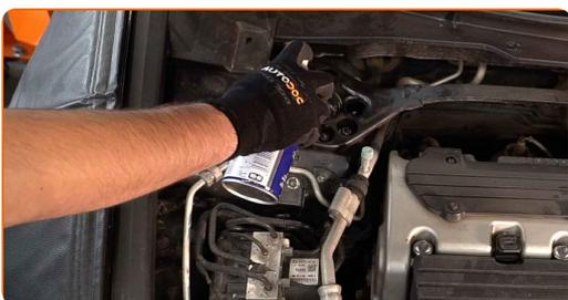
4 Dévissez la fixation supérieure du support d'amortisseur. Utilisez une douille n° 14. Utilisez une clé à cliquet.
