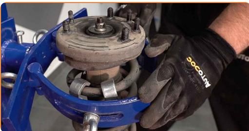
Remplacement : coupelle d'amortisseur – HONDA Accord VIII Break (CW). Les professionnels recommandent :
