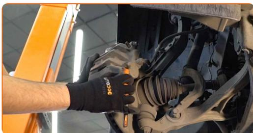
9 Dévissez l'attache de l'étrier de frein. Utilisez une douille n° 13. Utilisez une clé à cliquet.
