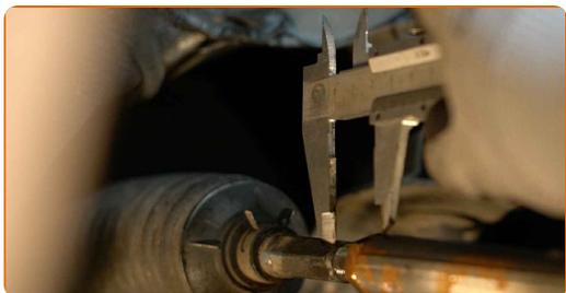
**18** Serrez l'écrou de blocage de l'extrémité de la barre. Utilisez une clé mixte de No.19 Utilisez une clé dynamométrique. Serrez-le jusqu'à 44 Nm.
