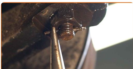
**8** Dévissez l'écrou d'attache d'extrémité à la fusée d'essieu. Utilisez une douille n° 17. Utilisez un porte-taraud.
