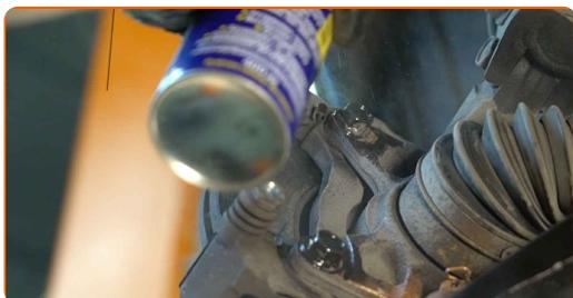
**13** Dévissez l'attache du support d'étrier. Utilisez une douille n° 19. Utilisez un porte-taraud. Utilisez une clé à cliquet.
