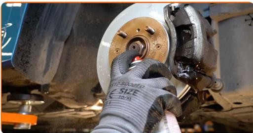
Remplacement : disques de frein – HONDA CIVIC V Hatchback (EG). Les experts d'AUTODOC recommandent :
