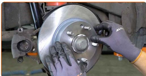
**28** Installez les boulons de fixation.
