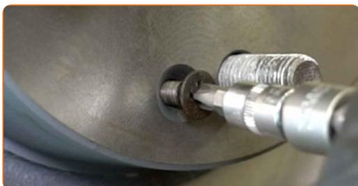
**29** Serrez les fixations du disque de frein. Servez-vous d'un tournevis Phillips. Utilisez une clé dynamométrique. Serrez-le jusqu'à 10 Nm.
