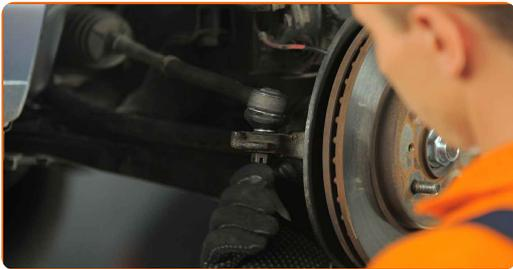
**59** Serrez l'écrou de fixation reliant l'embout de biellette de direction à la fusée d'essieu. Utilisez une douille n° 17. Utilisez une clé dynamométrique. Serrez-le jusqu'à 43 Nm.
