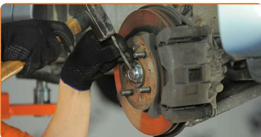
**57** Installez le capteur ABS sur la fusée d'essieu et fixez-le. Utilisez une douille n° 10. Utilisez une clé à cliquet.
