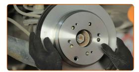
Serrez l'attache du disque de frein. Servez-vous d'un tournevis Phillips. Utilisez une clé dynamométrique. Serrez-le jusqu'à 9 Nm.
