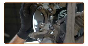
Serrez le support de l'étrier de frein. Utilisez une douille n° 14. Utilisez un porte-taraud. Utilisez une clé dynamométrique. Serrez-le jusqu'à 55 Nm.
