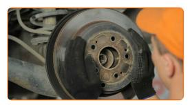
Nettoyez le moyeu. Utilisez une brosse métallique. Traitez la surface de contact. Utilisez de la graisse au cuivre.
