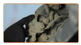
Dévissez l'attache de l'étrier de frein. Utilisez une clé mixte de No.17. Utilisez une douille n° 12. Utilisez une clé à cliquet.
