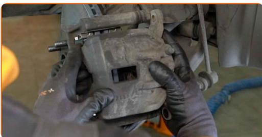
**39** Installez les boulons de fixation.
