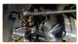
Vissez le filtre neuf en place. Utilisez la douille 65/14-F. Respecter bien le couple de serrage recommandé.
