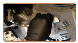
Vissez le nouveau bouchon de vidange et le resserrez. Utilisez une douille n° 17. Utilisez une clé dynamométrique. Serrez-le jusqu'à 39 Nm.
