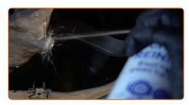
Dévissez le bouchon de vidange. Utilisez une douille n° 17. Utilisez une clé à cliquet.
