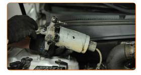
Dévissez le capteur de présence d'eau dans le carburant.
