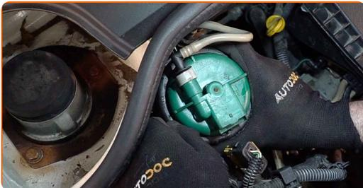
14 Attachez le connecteur du capteur de pression du carburant.
