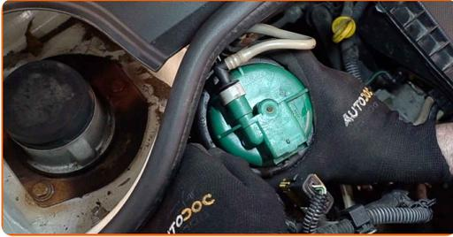
13 Nettoyer le connecteur du capteur de pression du carburant. Servez-vous d'un pulvérisateur pour pièces électroniques.
