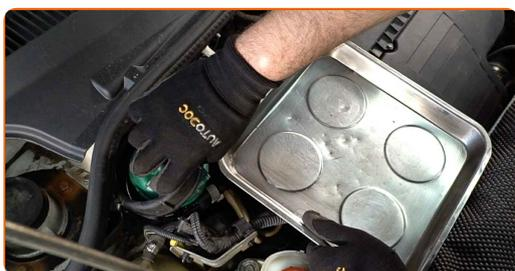
6 Dévissez le bouchon du compartiment du filtre, ainsi que l'ancien élément filtrant. Mettez l'ancienne cartouche de filtre dans le conteneur.
